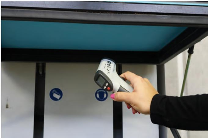
Die Innenseite sollte bei der OT TWO auf ca. 95°C und bei der OT ONE auf ca. 90°C durchwärmt sein – dann ist gewährleistet, dass auch der Materialkern richtig erwärmt ist.
