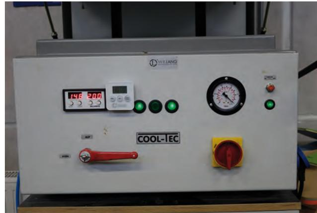
**Tipp:** Durch drücken des mittleren Kippschalters lässt sich der mittlere Quarzstrahler abschalten; diese Einzelschaltung ist ein wirklich sinnvolles Extra.
