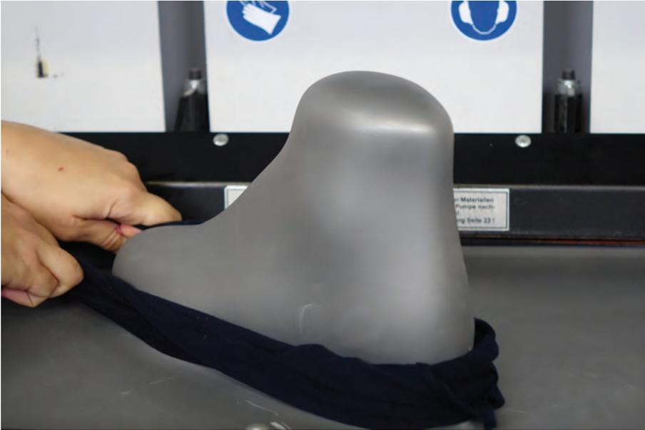
Eine weitere Möglichkeit zur Faltenvermeidung: Unterstützung der Anformung durch den Einsatz eines Tuches.
