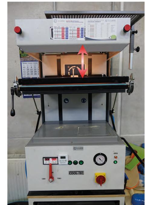
Den mittleren Quarzstrahler bei den hier verwendeten Platten abschalten – sonst wird die Mitte der Platte bis zu 15°C wärmer gegenüber der restlichen Platte.
