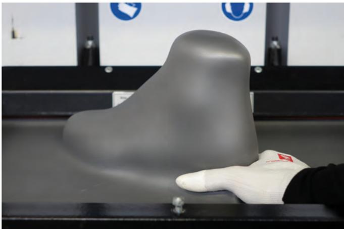
Zur besseren Anformung im Fersenbereich empfiehlt es sich mit einem Wärmehandschuh mittels „Spangengriff“ evtl. drohende Materialfalten zu vermeiden.
