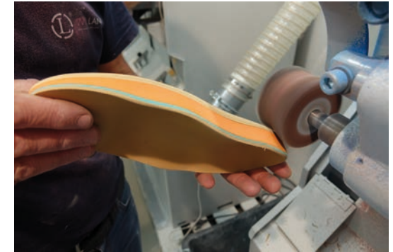
Anpassung in Bezug auf Gesamtstärke und Form der Brandsohle
