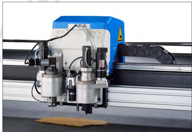
Schneidkopf eines Einzellagencutters. (Fotos: © Bullmer GmbH).
