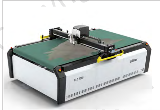
Einzellagencutter der Bullmer GmbH. (Fotos: © Bullmer GmbH).
