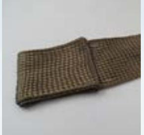
Die technischen Werte liegen knapp unter denen von „E-Glas“-Fasern. In Kombination mit der Nachhaltigkeit der Naturfasern und ihrer CO<sup>2</sup>-Neutralität ergeben sich große Einsparmöglichkeiten für faserverstärkte und gefüllte Kunststoffe.
