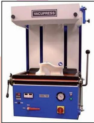
durch das integrierte COOL-TEC System können die Abkühlzeiten um bis zu 75 % reduziert werden.
