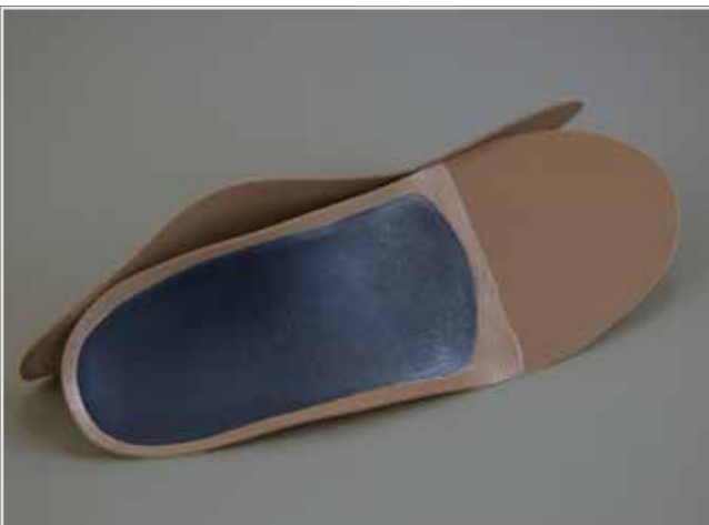
LaNe® Unterbau in Sport-Form 1/1, breit, flach, Unterbezug aus EVA spez. 60 Shore A 2 mm und Kern K 2.
